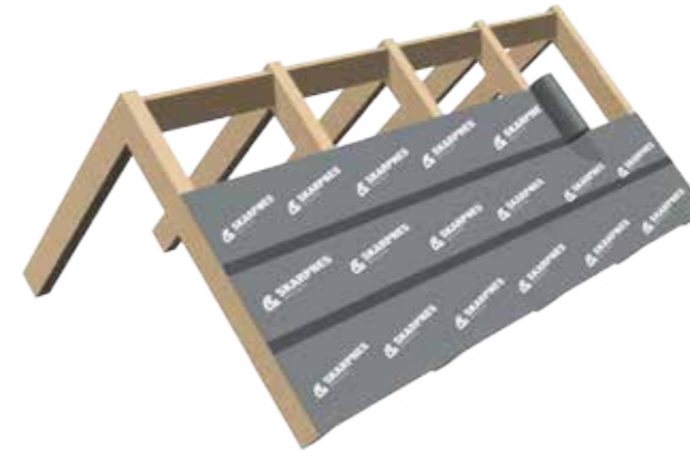
Fig. 2 viser monteringen av kombinert undertak og vindsperre på tvers av sperrene. Undertaket ruller ut på langs av takfoten, strammes godt og festes fortløpende til sperrene med pappstift. Ved legging skal tverrskjøter limes med Tape Xtreme, eller PE 60 og klemmes med sløyfe.
